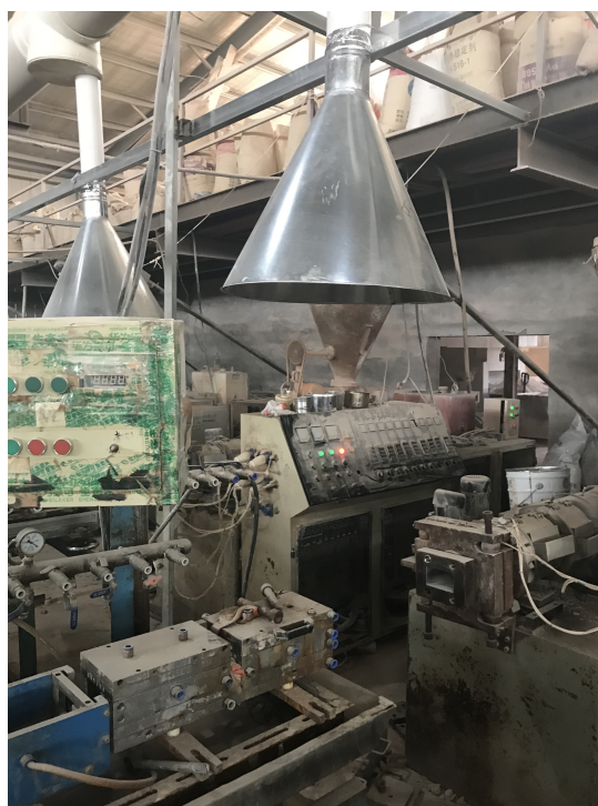
挤出机废气收集装置
